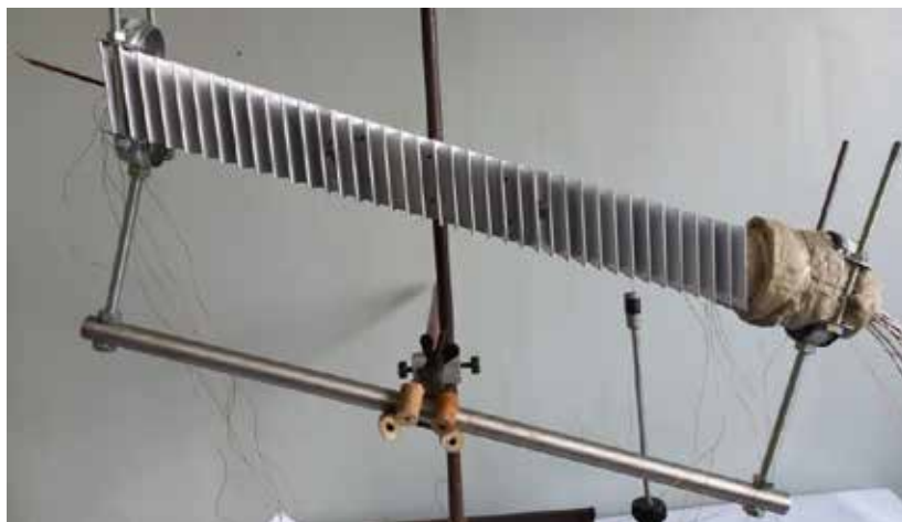
Рис. 4. Розміщення гравітаційної теплової труби на експериментальній установці
